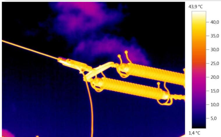
Проверка клеммного соединения изолятора (расстояние до объекта примерно 20 м)
