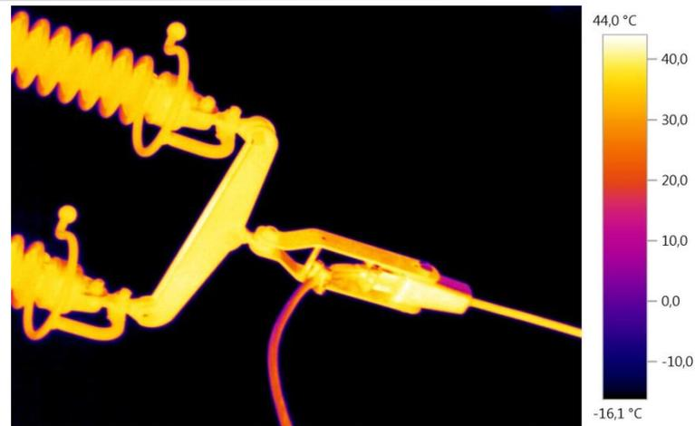
Проверка клеммного соединения изолятора (расстояние до объекта примерно 15 м)
